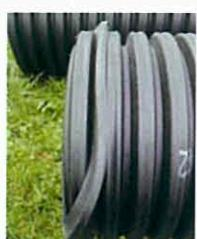
**Oblast použitia** pre splaškové a dažďové kanalizácie uložené v zemi, v perforovanom vyhotovení slúži ako drenážne alebo vsakovacie potrubie
