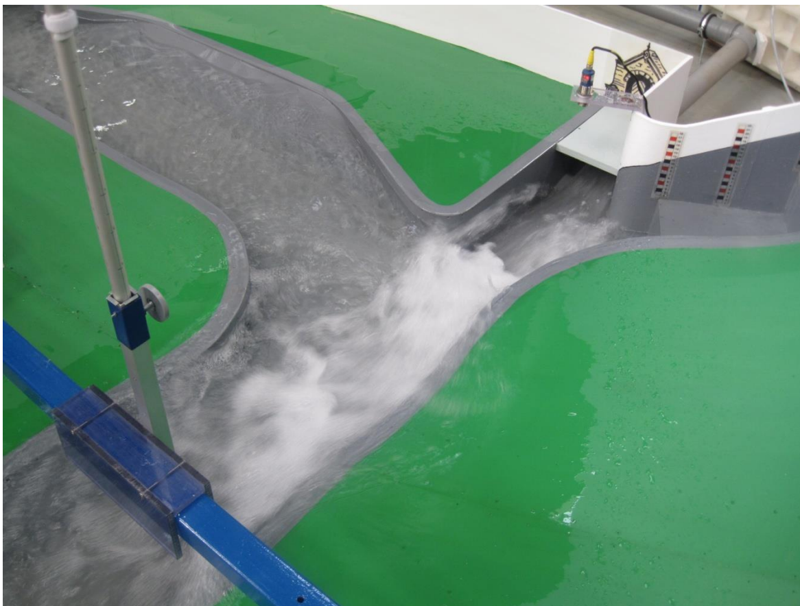
Obrázek 1- Pohled na nefunkční vývar při maximálním průtoku levou spodní výpustí (M4)
